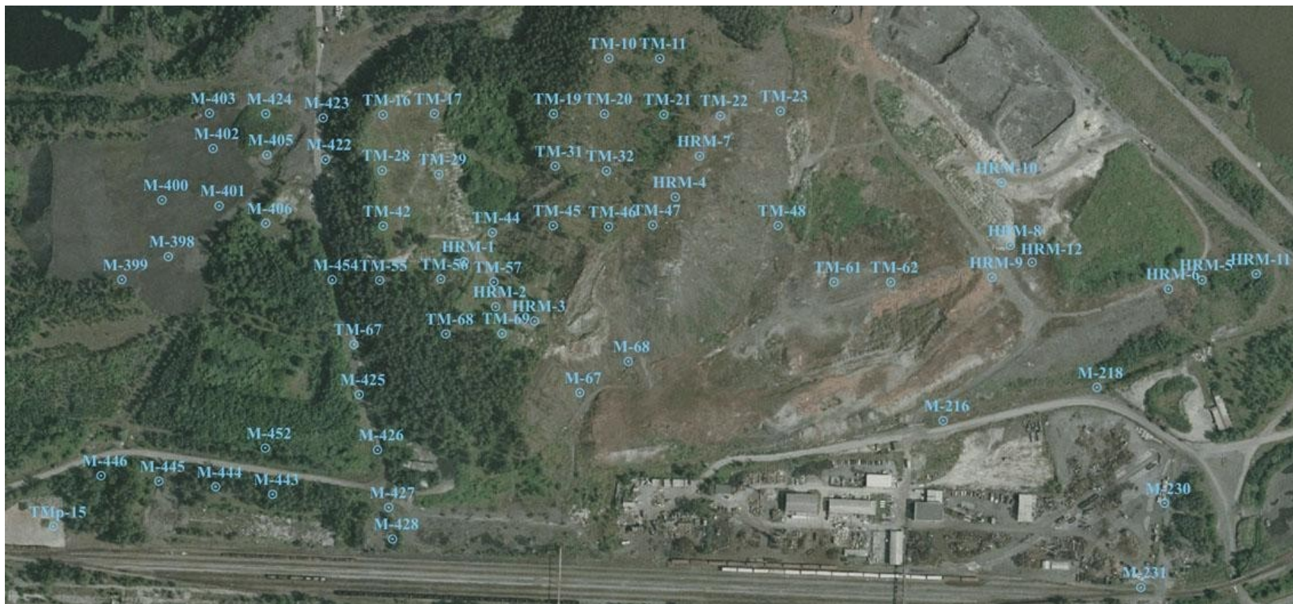
Mapa rozmístění termometrických sond v termicky aktivní oblasti
